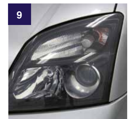
NACHHER Scheinwerferscheibe wieder klar Eintrübung und Vergilbung entfernt, Scheibe hochwertig, dauerhaft versiegelt
